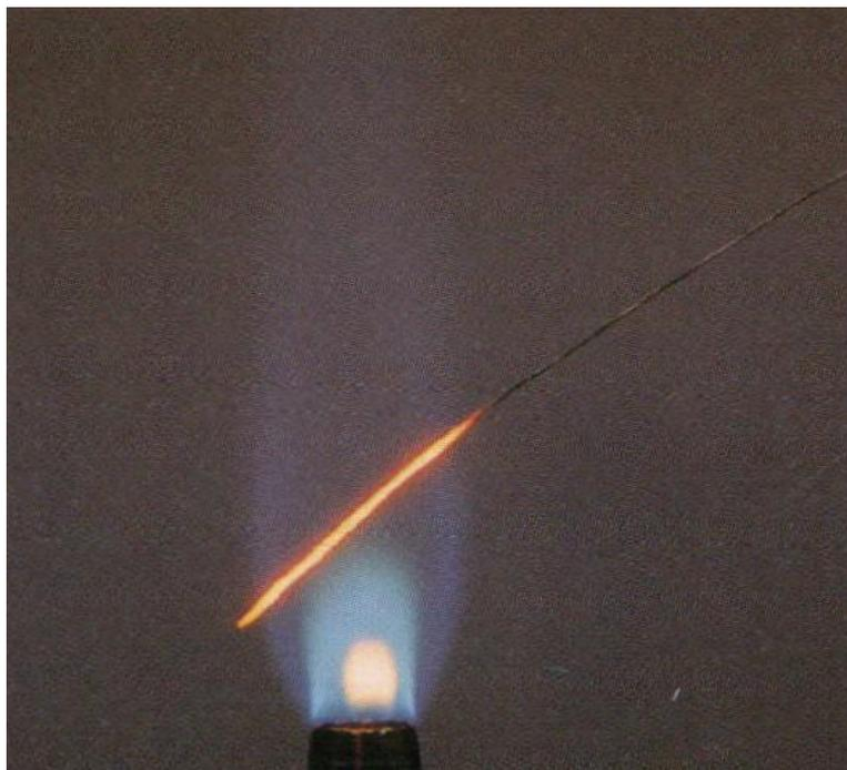
Tremper un fil de fer dans une solution de chlorure de sodium et le présenter à la flamme.
